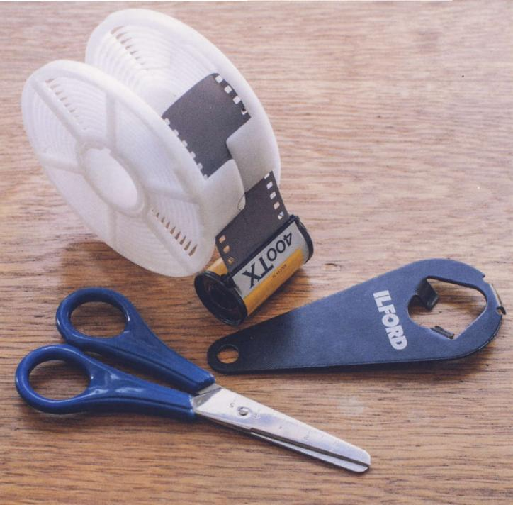
**Der Kleinbildfilm lässt sich im Hellen für das Aufspulen auf die Entwicklerspule vorbereiten. Im Dunkeln (oder im Dunkelsack) kommt der Dosenöffner zum Einsatz. Der Film wird aufgespult und mit der Schere abgeschnitten.**
